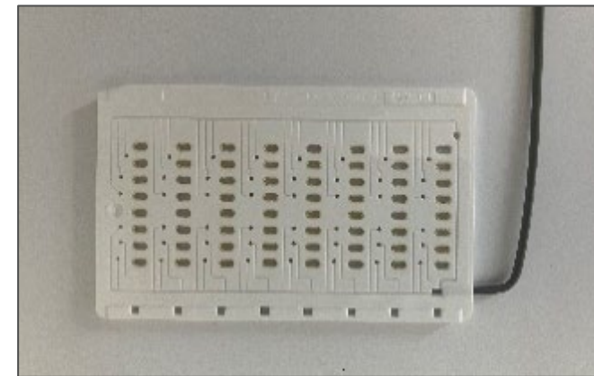
Abb.2: Miniaturisierte und automatisiert messbare Variante der turbidimetrischen Messung.
