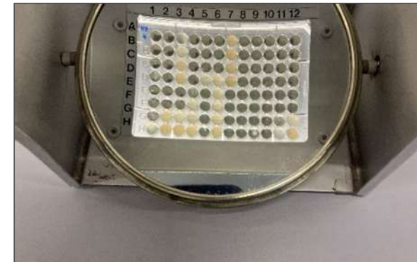
Abb.1: Turbidimetrische Messung in einer 96-Well Platte. Innerhalb einer Verdünnungsreihe zeigt das Well mit der Konzentration ohne Trübung die minimale Hemmkonzentration.
